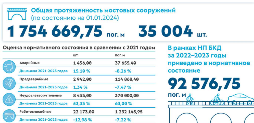
Рис. 2. Общее количество дорожных сооружений на региональных дорогах и динамика изменения их состояния
